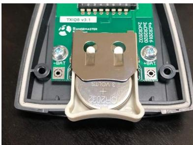
Чтобы обеспечить хороший контакт батарей, каждый раз при замене батарей зажимайте соединительные части держателя батарей внутрь:
