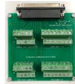
**ПЛАТА EASYCON для ПОДКЛЮЧЕНИЯ МИКРОФОННЫХ КАБЕЛЕЙ**
